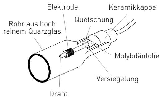
Diese Lampen werden mit einer Spiker-Maschine hergestellt: das erwärmte Quarzglas wird zwischen zwei Hämmern gedrückt.
