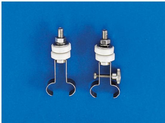
Als Zubehör empfehlen wir Klemm- und Halterfeder aus Edelstahl für die Montage der UV-Lampen in den Öfen. Diese Klemm- und Halterfeder werden spezifisch mit einer Edelstahlart für Helios produziert, die auch hohe Temperaturen ( $\rightarrow 1000^{\circ}\text{C}$ ) mit einer kontrollierten Expansion widersteht. Unsere technische Abteilung ist in der Lage, den Kunden zu beraten, um die richtigen Feder für die verwendete Lampe auszuwählen und ihnen die korrekte Montage zu empfehlen.
