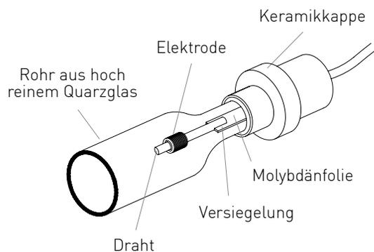
Diese UV-Lampen werden an der Drehmaschine hergestellt, indem das Vakuum in der Lampe dazu verwendet wird, den Druckunterschied herzustellen, der für das Schmelzen des erwärmten Quarzglas um die Molybdänfolie herum erforderlich ist.
