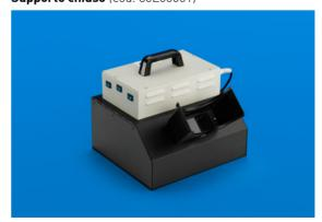
Scatola con finestra centrale, a base rettangolare con due chiusure, visione totalmente oscurata. Utile per l'inserimento di lastre cromatografiche della massima dimensione di 200 x 200.
