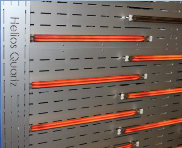
Diese Module bestehen aus Platten aus Edelstahl, die völlig verkabelt und mit Thermofühler ausgestattet sind. Sie sind fertig für die IR-Strahler von Helios Italquartz.
